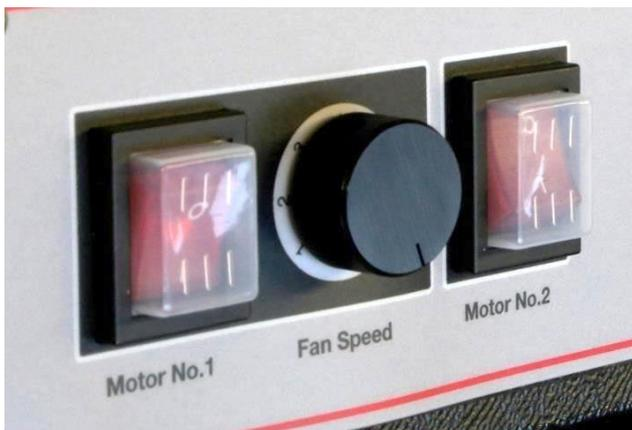
N.B. : Les NPU (unité de pression négative) de Beacon sont équipées d'un bouton de commande pour chaque ventilateur et chaque ventilateur a la possibilité de fonctionner à une vitesse différente, pour une plus grande polyvalence.
